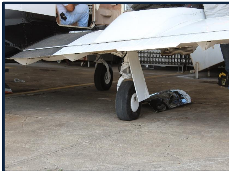
Fotografía No. 12 Vista del tren principal derecho sin daños.
