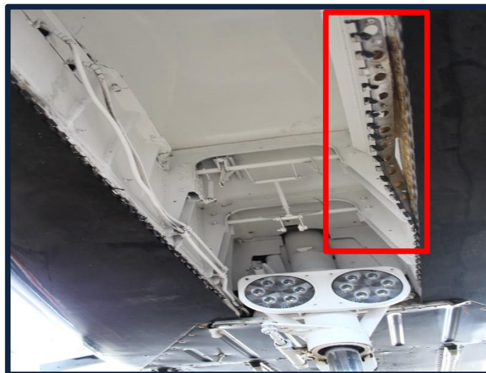
Fotografía No. 14 Vista de la bahía del tren delantero con daños en las compuertas y bisagras.
