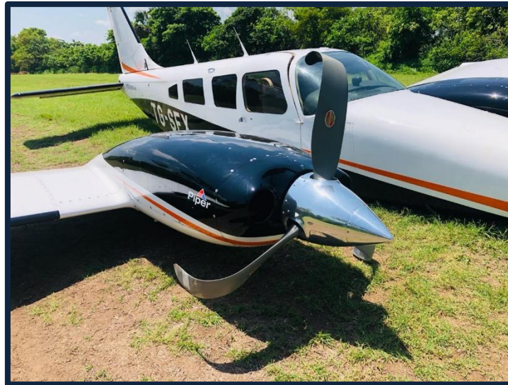
Fotografía No. 3 Vista de daños en las aspas de la hélice derecha.
