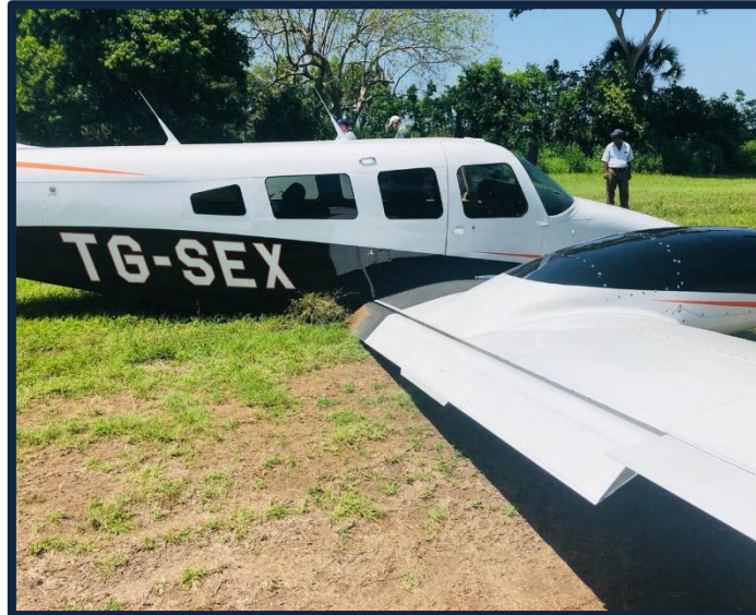
Fotografía No. 7 Vista de la aeronave sobre la superficie con daños en flaps.
