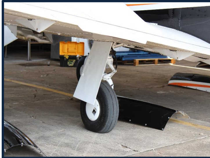
Fotografía No. 13 Vista del tren principal izquierdo sin daños.
