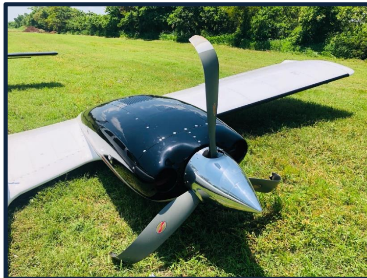
Fotografía No. 4 Vista de daños en las aspas de la hélice izquierda.
